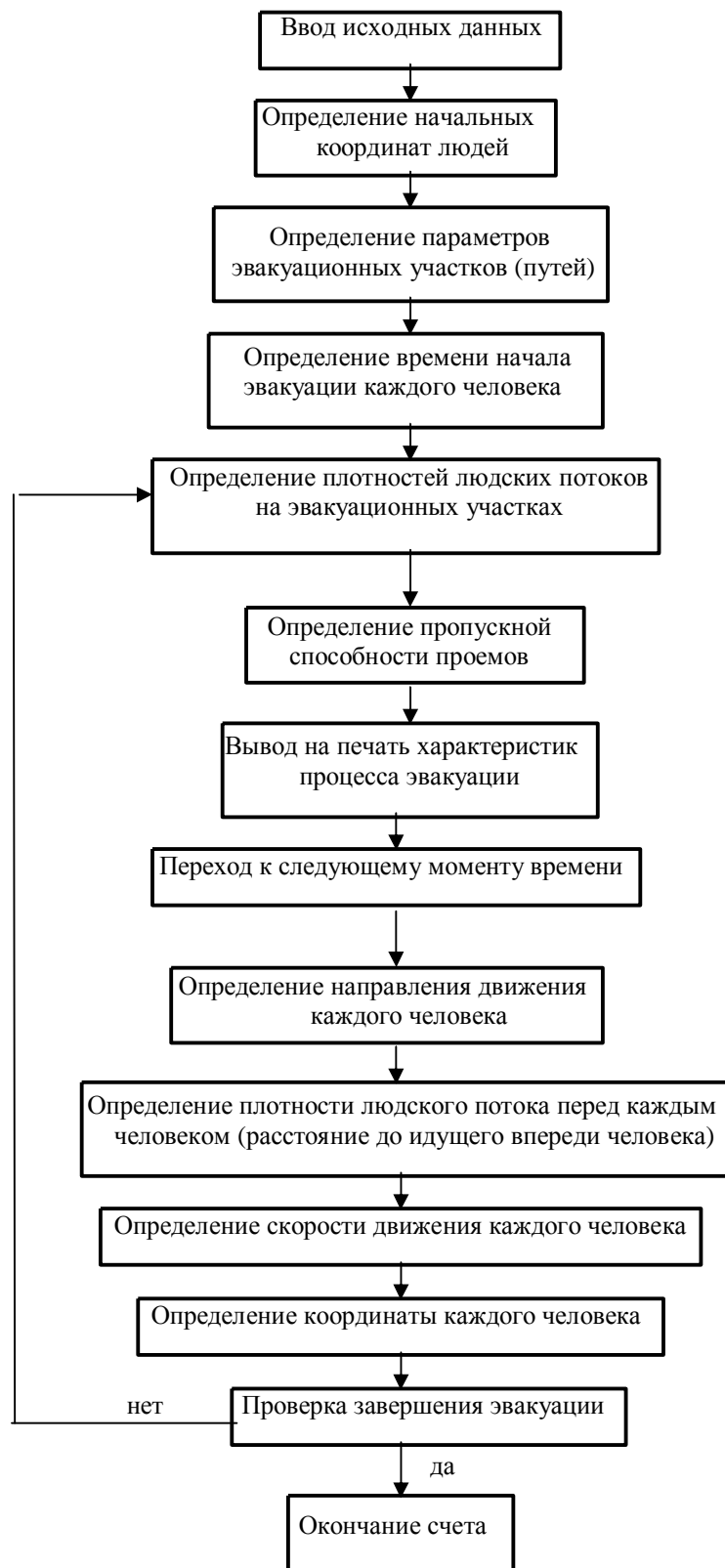
Рис. ПЗ.2. Блок-схема определения расчетного времени эвакуации людей из здания
